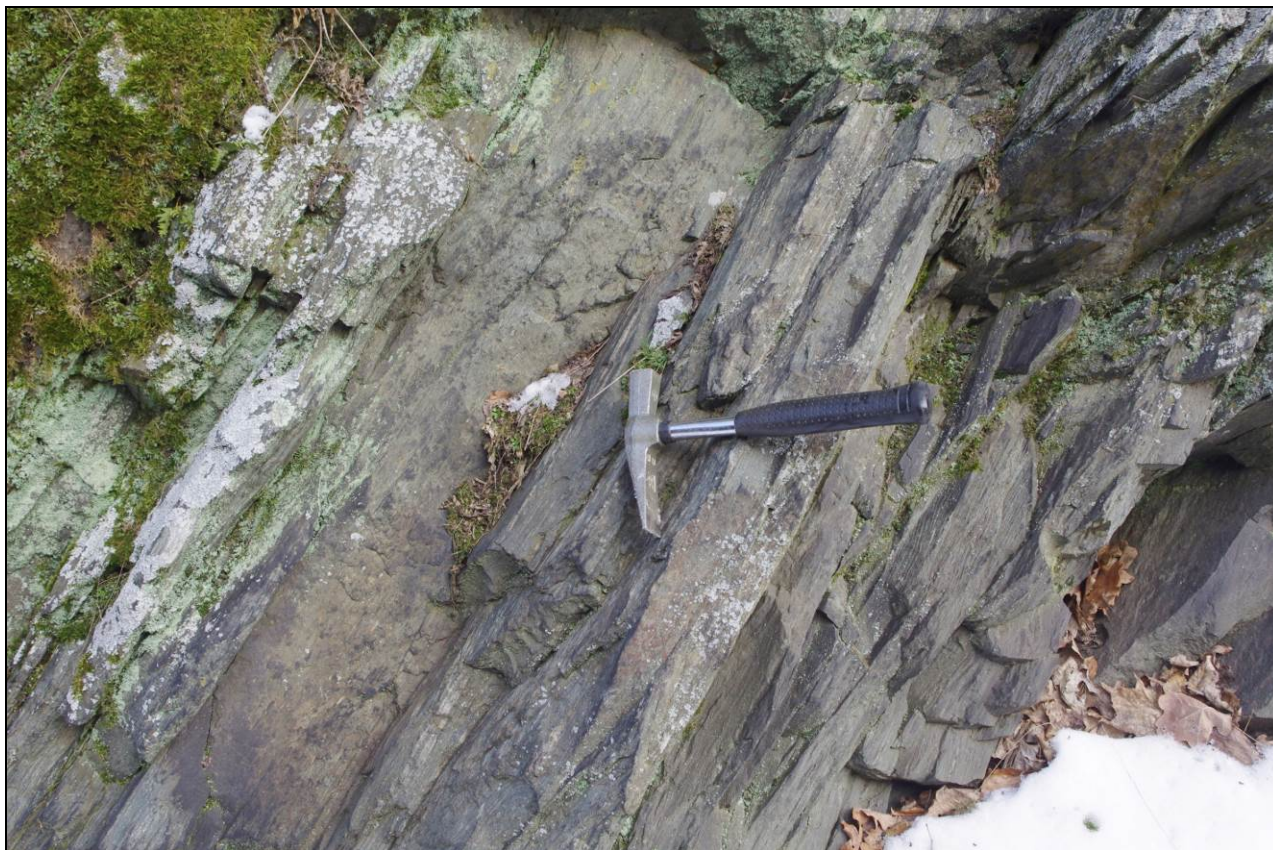
Foto – 8 Pohled vpravo na uspořádání puklinových systémů v km 27,300.
